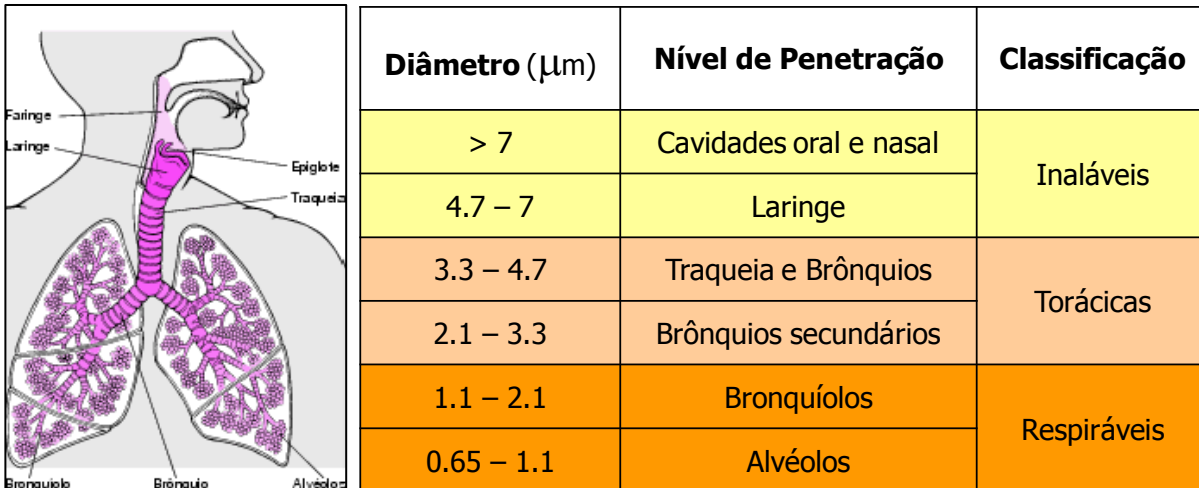
Figura 2 – Classificação das partículas em função do nível de penetração no sistema respiratório
